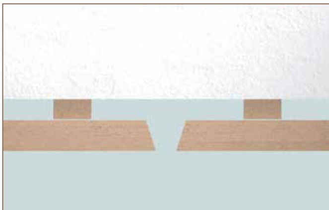
Kaschieren der Hohlkammer durch Schrägschnitt.
