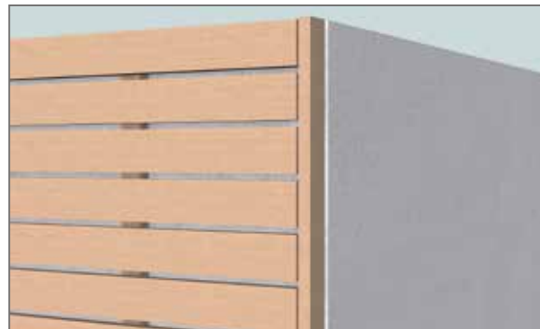
Verdecken der Hohlkammer mit der Abschlussleiste (3D-Ansicht).
